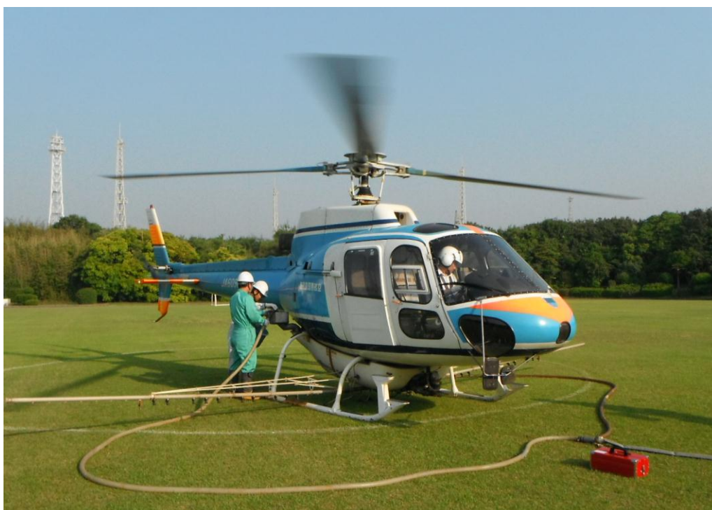
松くい虫駆除剤を空中散布するためヘリコプターに薬剤を注入する様子
