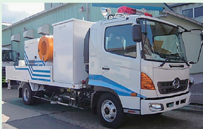
排水ポンプ車の導入を
