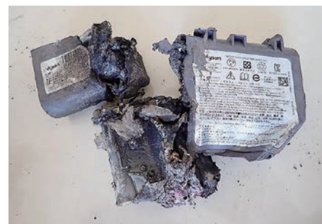
西都児湯クリーンセンターで出火原因となった加熱式たばこの本体(上)と掃除機のバッテリー(下)
