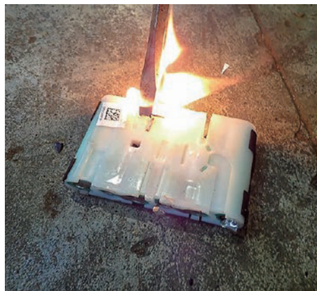
掃除機のバッテリーに鉄製品をつけて発火した実験画像
