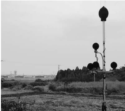
溜水地区の民家に設置している騒音測定装置の集音マイク
